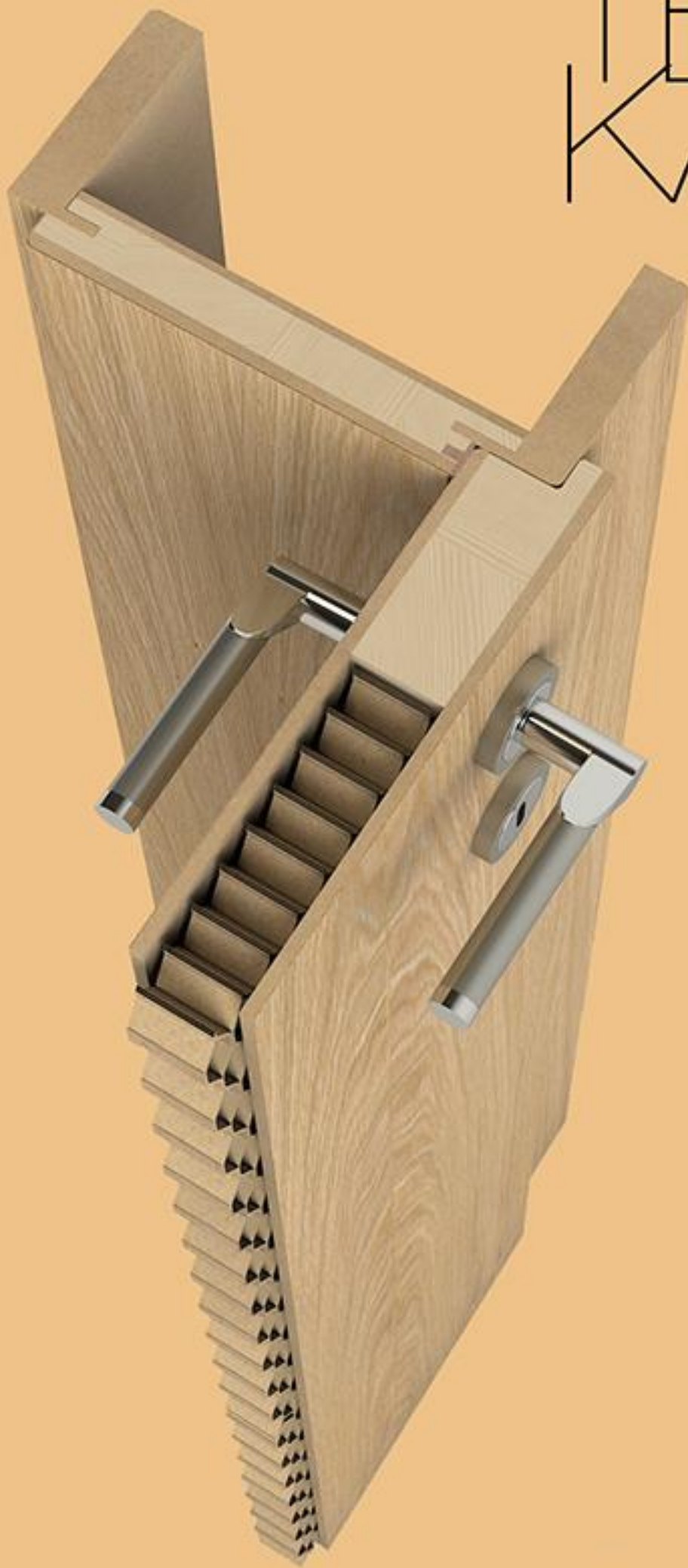
Presjek modela dovratnika 23mm Presjek vratnog krila 42mm sa falcom, ispuna papirna sać
